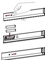
1. Deslice la cubierta trasera para abrir el compartimento de pilas del mando a distancia.
