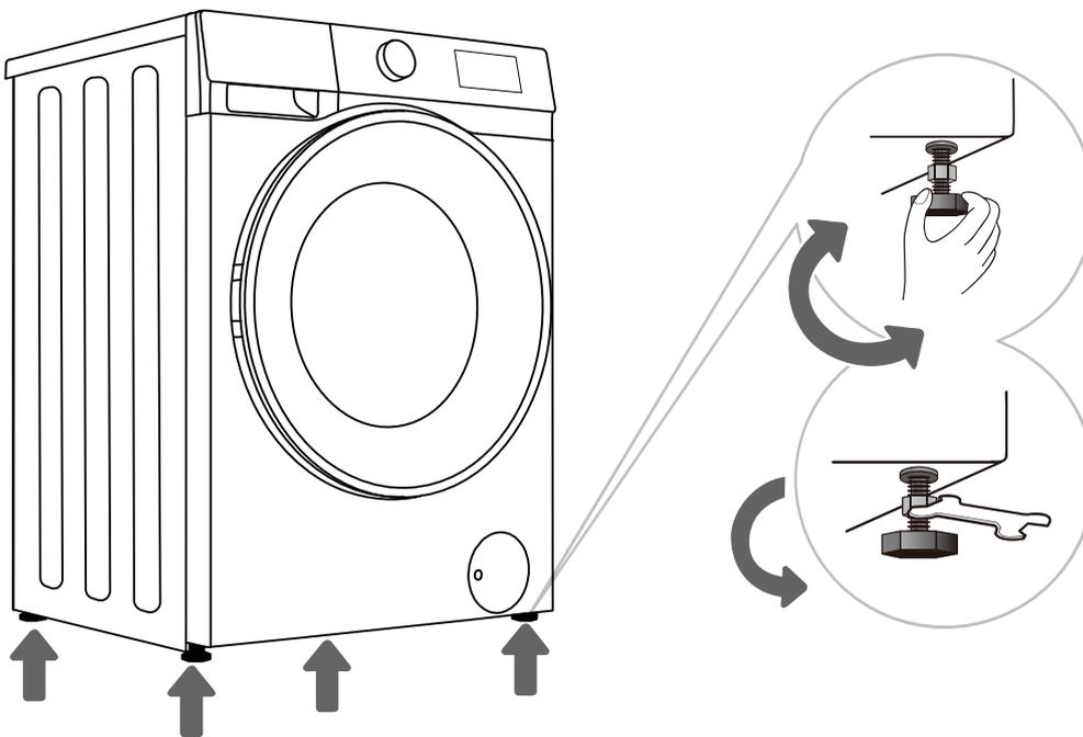
**1** Gire los pies ajustables hasta nivelar la máquina. Los pies permiten nivelación en +/- 2 cm.
