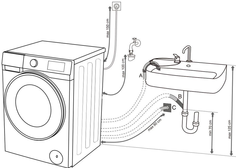
**C** Además, la manguera de drenaje puede conectarse a un drenaje de pared con un colector de agua, el cual debe ser instalado de manera apropiada para permitir la limpieza.
