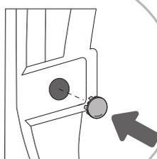
**1** Mueva a un lado las mangueras y utilice una llave de ajuste para aflojar los 4 tornillos en la parte posterior del aparato haciéndola girar en sentido antihorario, como se indica mediante la flecha. Aflojélos aproximadamente 30 mm.
