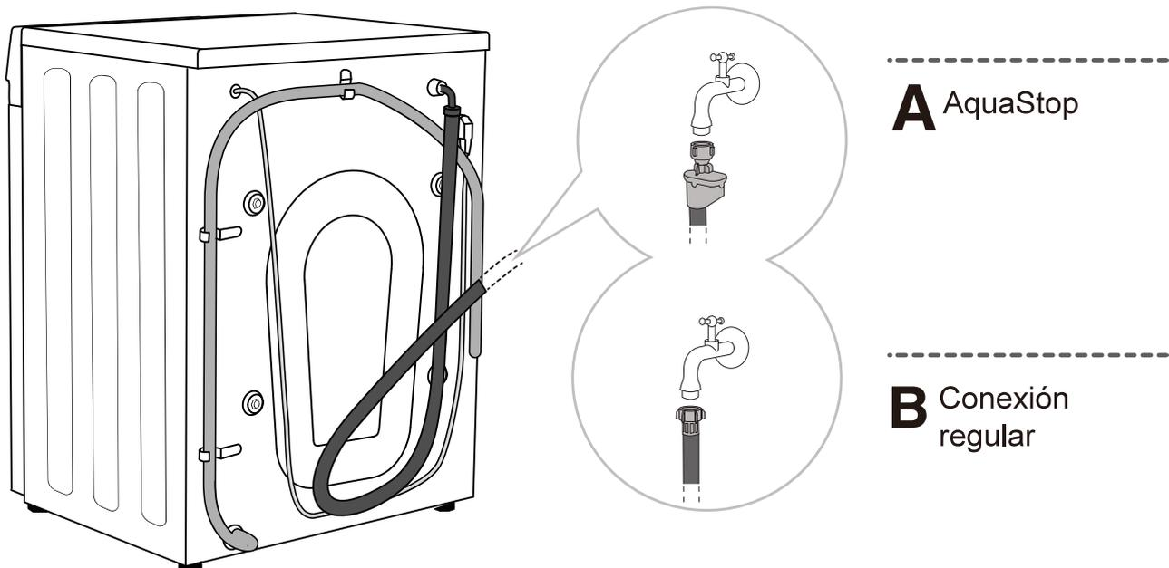
☼ Para un funcionamiento normal de la máquina, la presión del agua debe estar entre 0,1-1 MPa (1-10 bar; 1-10 kp/cm<sup>2</sup>; 10-100 N/cm<sup>2</sup>). La presión de agua mínima dinámica se puede determinar midiendo el flujo de agua. 3 litros de agua deben fluir desde un grifo completamente abierto en 15 segundos.
