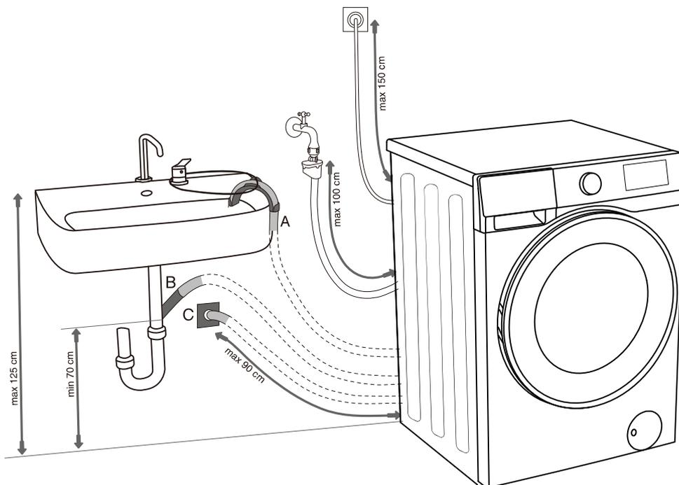
**A** El extremo de la manguera de drenaje se puede colocar sobre un fregadero o una bañera. Utilice una brida para asegurar la manguera a través del soporte de codo para evitar que se deslice.
