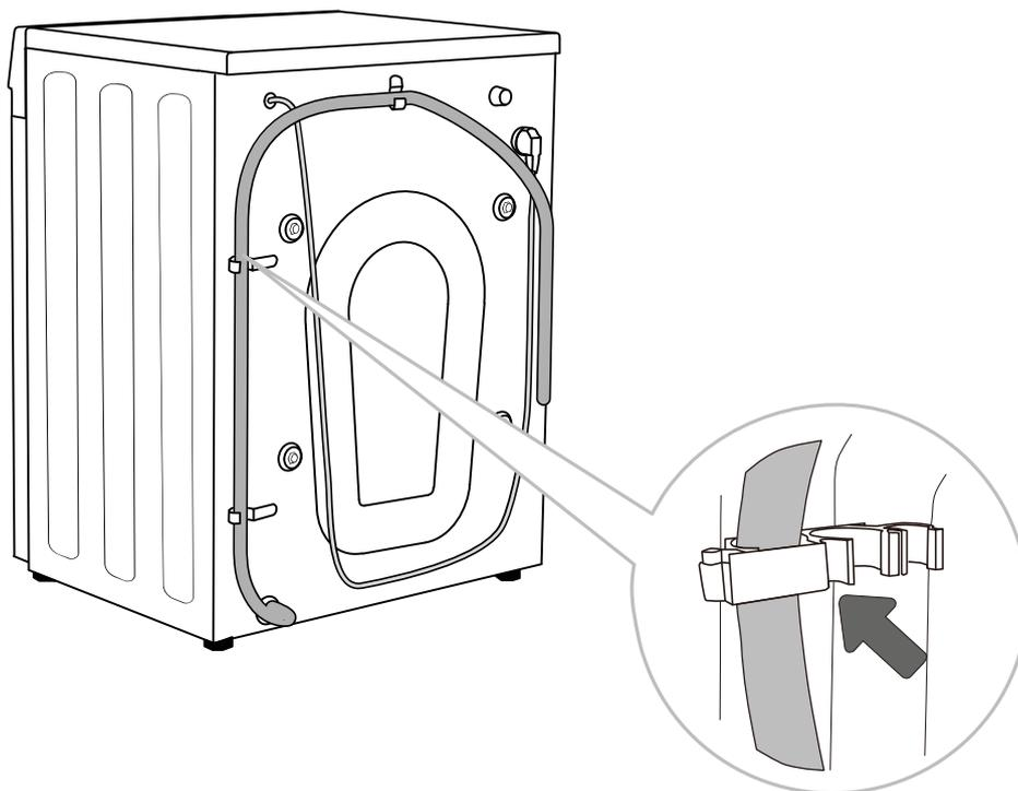
**D** La manguera de drenaje debe ser conectada a los ganchos en la parte posterior de la máquina, como se muestra en la figura.
