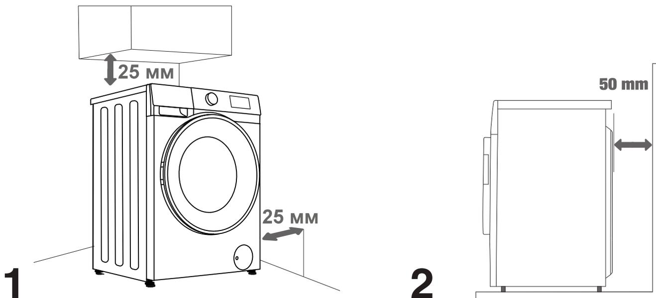
⚠ La máquina no puede estar en contacto con una pared o mueble. Para un funcionamiento óptimo de la máquina, deje un poco de espacio alrededor de la máquina, como se indica en la figura.
