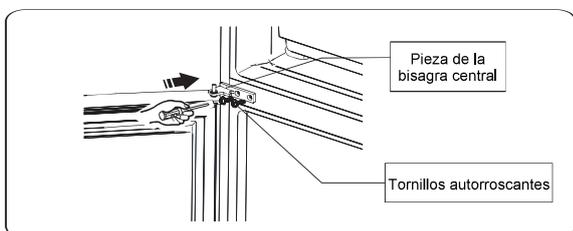
14. Cambie la puerta superior a la posición adecuada. Asegure el nivel de la puerta y coloque el eje de la bisagra central en el orificio inferior de la puerta superior.
