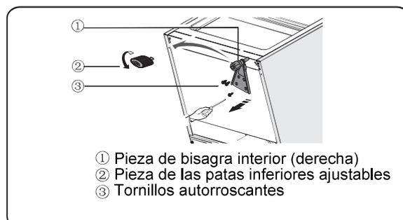
11. Vuelva a colocar la pieza de arandela inferior en el lado izquierdo y fíjela con los tornillos autorroscantes de la brida especial. Vuelva a colocar las patas inferiores ajustables en el otro lado y fíjelas.
