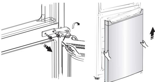
8. Coloque la puerta inferior sobre una superficie suave con el panel hacia arriba. Afloje el tornillo ② y la pieza ① y, a continuación, instálelos en el lado izquierdo y apriete bien.
