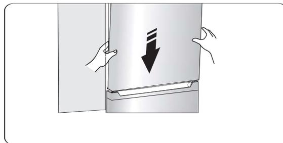
15. Cambie la pieza de la bisagra superior y coloque el eje de la bisagra superior en el orificio superior de la puerta superior y ajústela en la posición de la puerta superior (sujete la puerta superior con la mano mientras lo haga), fijando la pieza de la bisagra superior con los tornillos autorroscantes de la brida especial.
